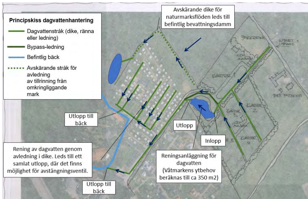
Figur 15. Principskiss över föreslagen dagvattenhantering (ej skalenlig).
