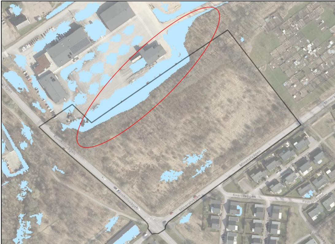
Figur 6. Maximal utbredning av befintliga lågpunkter inom och i närheten av planområdet (SCALGO Live).
