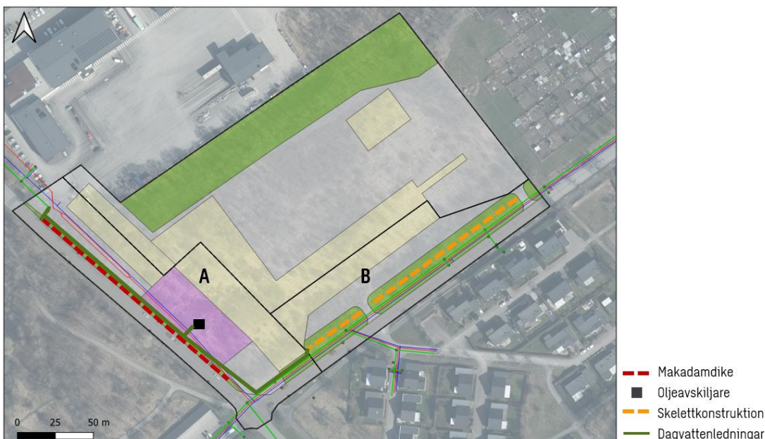
Figur 16. Föreslagen dagvattenhantering i delområde A och B. I figuren visas även befintliga dagvattenledningar i tunna gröna streck, dricksvattenledningar i blåa streck samt spillvattenledningar i röda streck.
