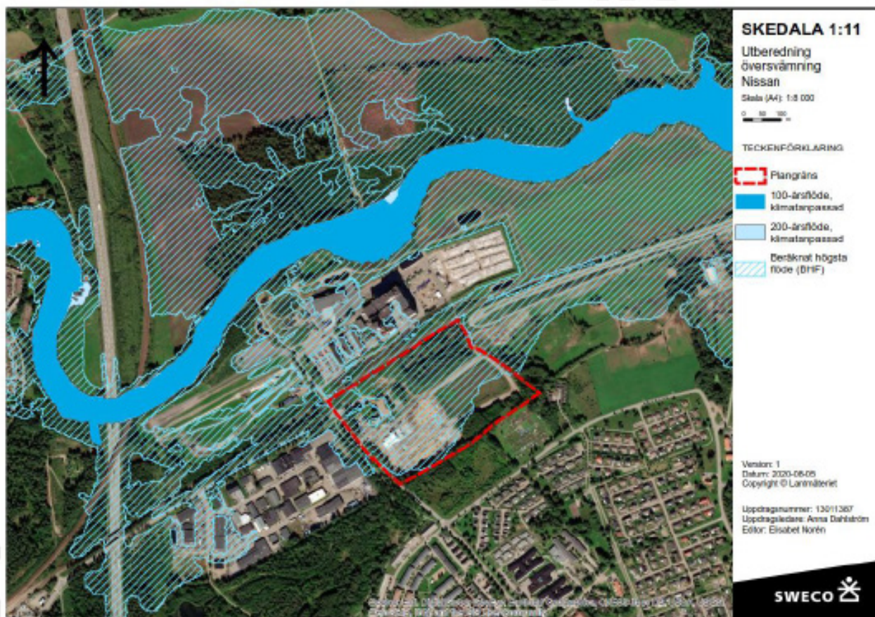
Figur 13. Översvämningsutbredning vid höga flöden i Nissan. Utbredningen är hämtad från Översvämningsportalen (MSB, 2020).
