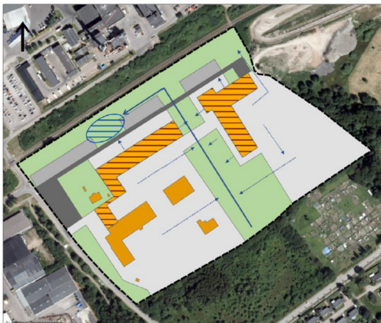
Figur 18. Figuren visar rekommenderade sekundära avrinningsvägar vid skyfall, dvs. lågstråk och lutningar i terrängen där stora volymer vatten kan avrinna.
