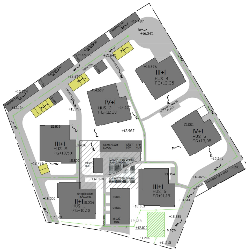
Figur 13. Föreslagen avrinning för planområdet, flödespilar i svart.
