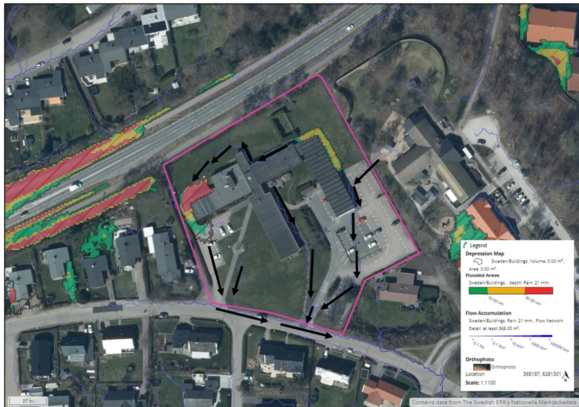
Figur 4. Rinnvägar och lågpunkter för ett 10-årsregn (Lantmäteriet, 2021).
