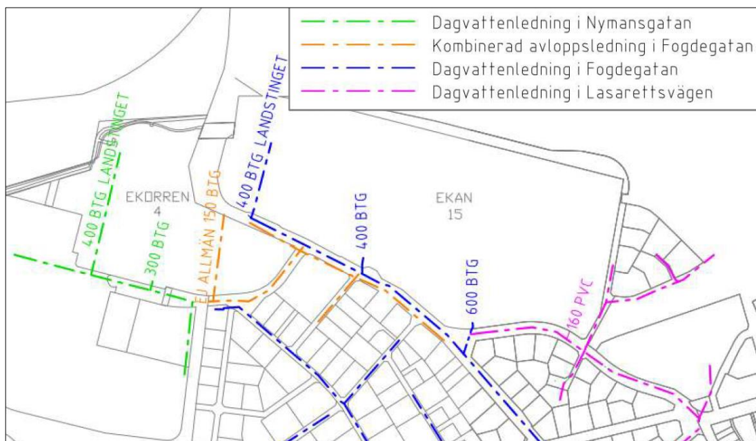
Figur 9 Befintligt ledningssystem inom planområdet. (Sweco 2019)
