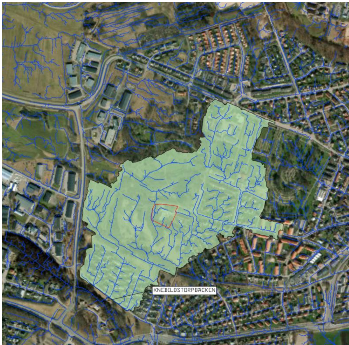
Figur 9 Avrinningsområde och ytliga rinnvägar för planområdet i händelse av ett skyfall. Figuren visar endast yttliga skyfallsstråk med en tillrinnande area om minst 0,5 ha. Ungefärlig planområdesgräns markerat i rött.
