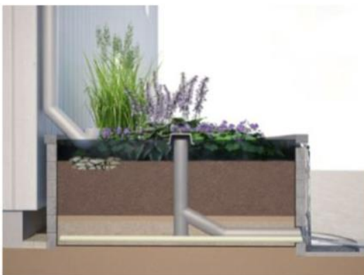
Figur 16 Upphöjd växtbädd i direkt anslutning till stuprör (Halmstads kommun, 2023)
