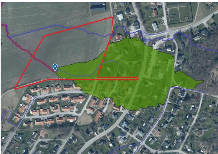
Figur 9 Delavrinningsområde 2 (grön yta) och ytliga rinnvägar som inträffar i händelse av ett skyfall. Planområdets ungefärliga gräns markerat i rött. Illustration framtagen i SCALGO Live.
