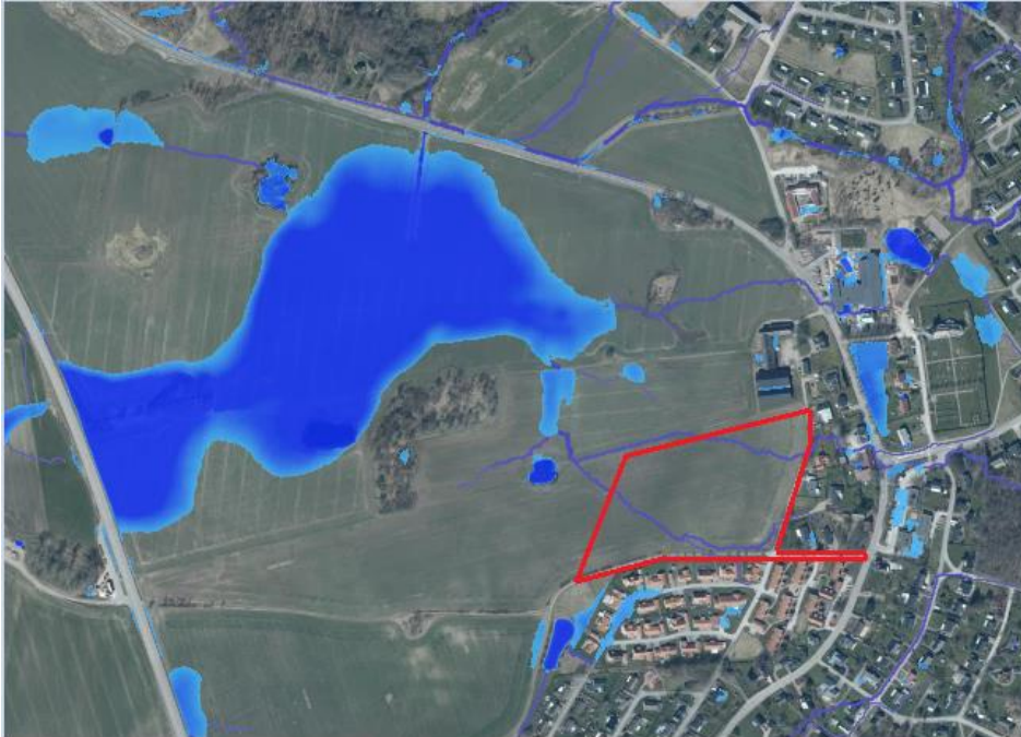
Figur 10 Lågpunktsanalys utförd i SCALGO Live. Figuren visar ytliga skyfallsstråk som har en tillrinnande area på minst 1,5 ha samt uppfyllnad av lågpunkter vid studerad regnvolym på 90 mm. Planområdets ungefärliga gräns markerat i rött.
