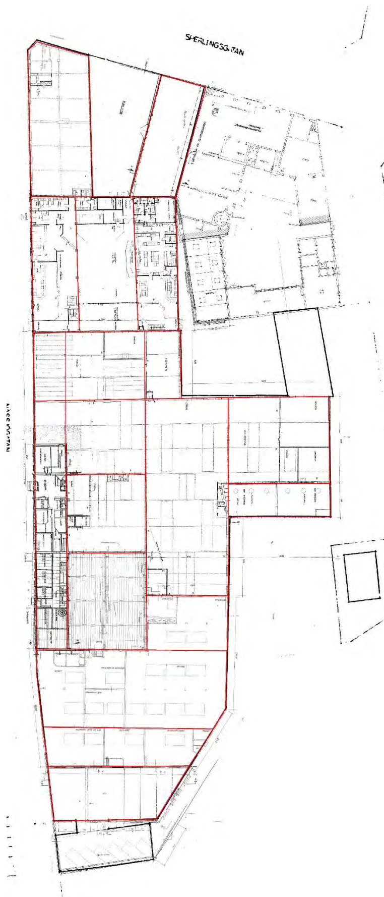
Figur 37 Sammanläggning av ritningar över bottenplan med pelarae och ballkar illustrerade. Röda linjer markerar huvudsakliga delningsmöjligheter.
