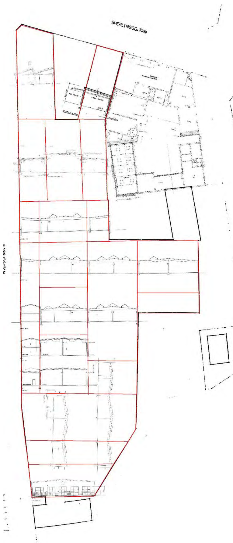
Figur 36 Sammanläggning av byggnadskropparna på fabriksbyggnaden med inlagda sektioner som visar konstruktionens riktningar och takelementens storlek. Röda linjer markerar huvudsakliga delningsmöjligheter.
