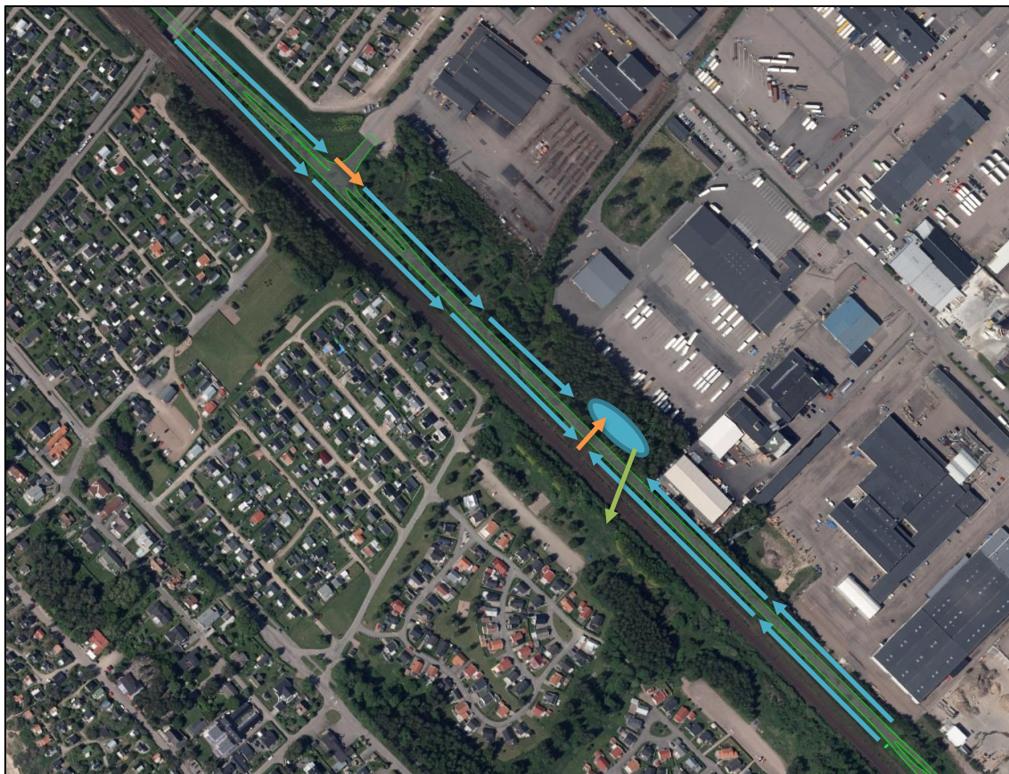
Figur 6. Principskiss över föreslagen dagvattenhantering. Svackdiken leder vägdagvattnet till torr damm där anslutning till befintligt dagvattennät sker. Översilning och infiltration i svackdikena samt sedimentering och infiltration i den torra dammen renar dagvattnet. Blåa pilar visar flödesriktning i svackdiken. Orangea pilar visar trummor. Blå cirkel är område där den torra dammen rekommenderas att utformas. Grön pil visar anslutning till befintligt dagvattennät.
