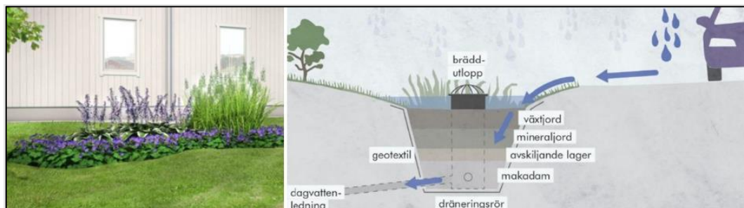
Figur 12. Illustration av nedsänkt växtbädd. Illustrationen är hämtad från dagvattenutredningen. (SWECO, 2021).
