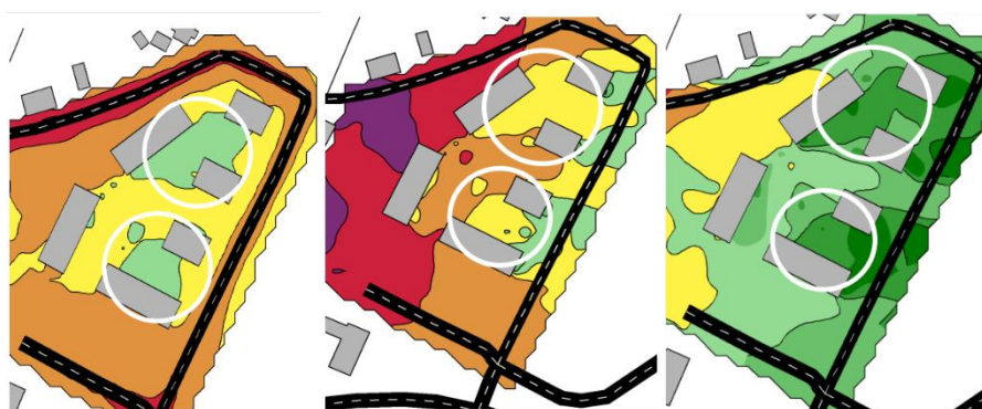
Figur 24. Figuren visar områden där riktvärdet för buller uppfylls (grönt) respektive där riktvärdet inte uppfylls (gul, orange, rött och lila). De vita ringarna i det norra och södra området anger ungefärligt område där den ekvivalenta ljudtrycksnivån beräknas innehålla riktvärdet.
