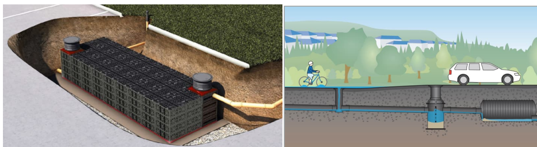
Figur 6. Exempel på dagvattenkassetter och rörmagasin
