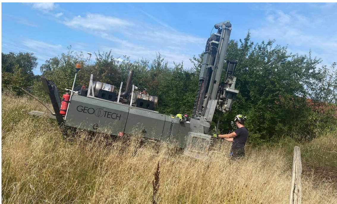
Figur 3. Jordprovtagning med borrhandsvagn vid provpunkt TR2.
