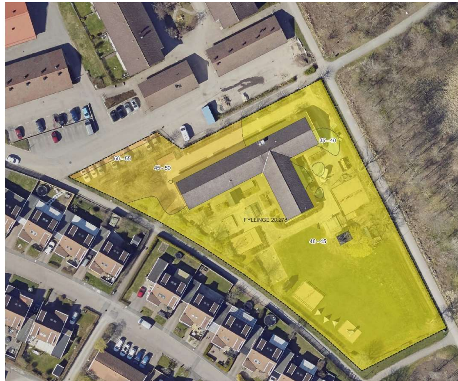
Figur 3. Exempelkarta, utbredning av ekvivalent ljudnivå i dB(A) på Klackens förskola i Fyllinge
