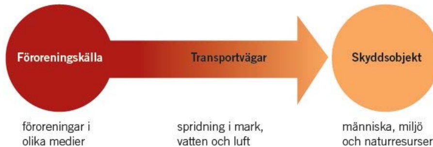
Figur 34. En risk föreligger när förorening från en källa (t.ex. jord eller grundvatten) frigörs och via olika transportvägar sprids och exponerar skyddsobjekt (människa, miljö, naturresurser) så att en negativ effekt kan uppstå. Figur från Naturvårdsverket (NV 2009a).
