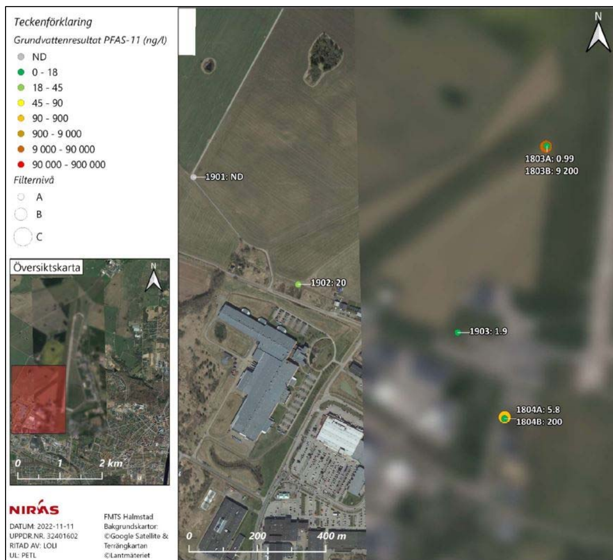
Figur 14. I figuren redovisas uppmätt halt PFAS-11 i ng/l i grundvattenprov uttagna år 2022 från grundvattenrör med placerat filter på olika djupnivåer (benämns A, B, C) vid FMTS och flygplatsens västra område. Figur från Niras 2022.
