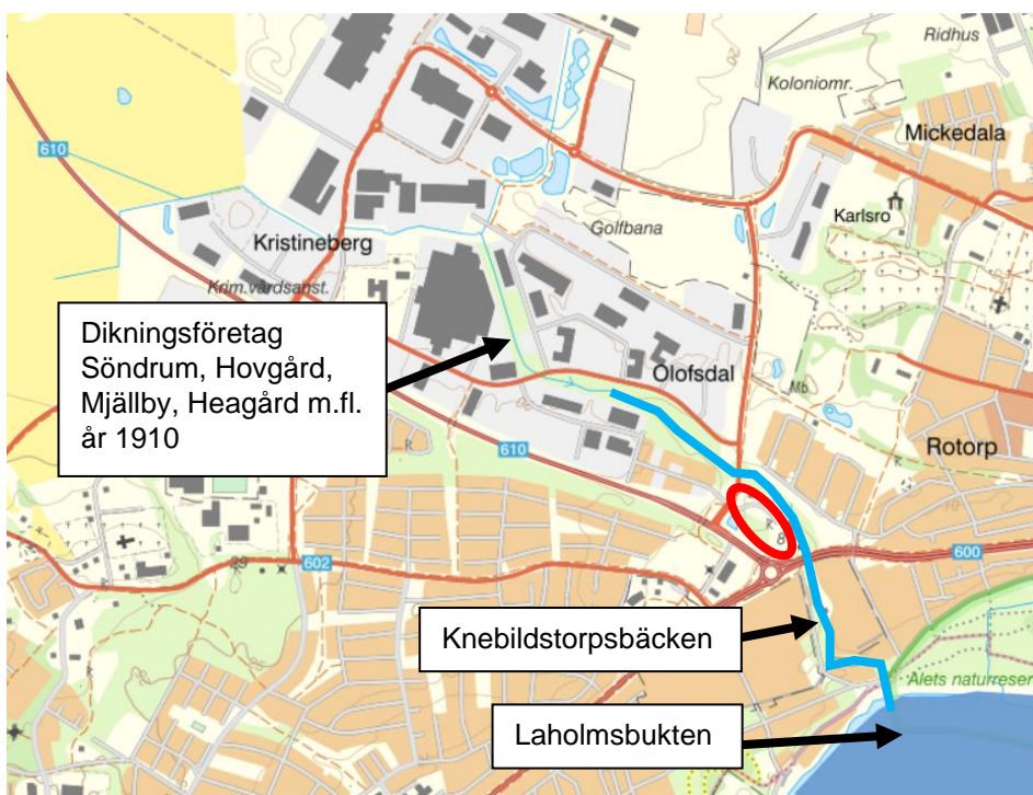
Figur 6 Översikt över befintlig yttlig avvattning uppströms samt nedströms planområdet. Planområdets ungefärliga avgränsning är markerat med rött elips. Bakgrundsbild: VISS Vattenkartan 2024.
