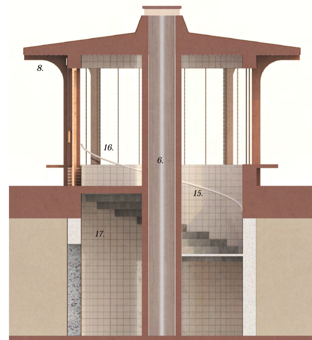
Sektion trapphus (gäller bägge paviljongerna), skala 1:50
