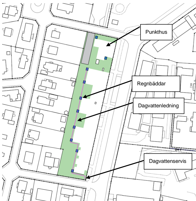
Figur 11 Illustration av föreslagen dagvattenlösning. Notera att lösningen endast är schematiskt utritad. Lösningen behöver anpassas till de platsspecifika förhållandena, t.ex. stuprörens placering.
