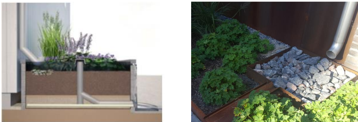
Figur 12 Inspiration till dagvattenhantering i anslutning till stuprör. Upphöjd regnbädd samt stenlista i anslutning till stuprör (Halmstad kommun, 2022), (Sweco, 2024).
