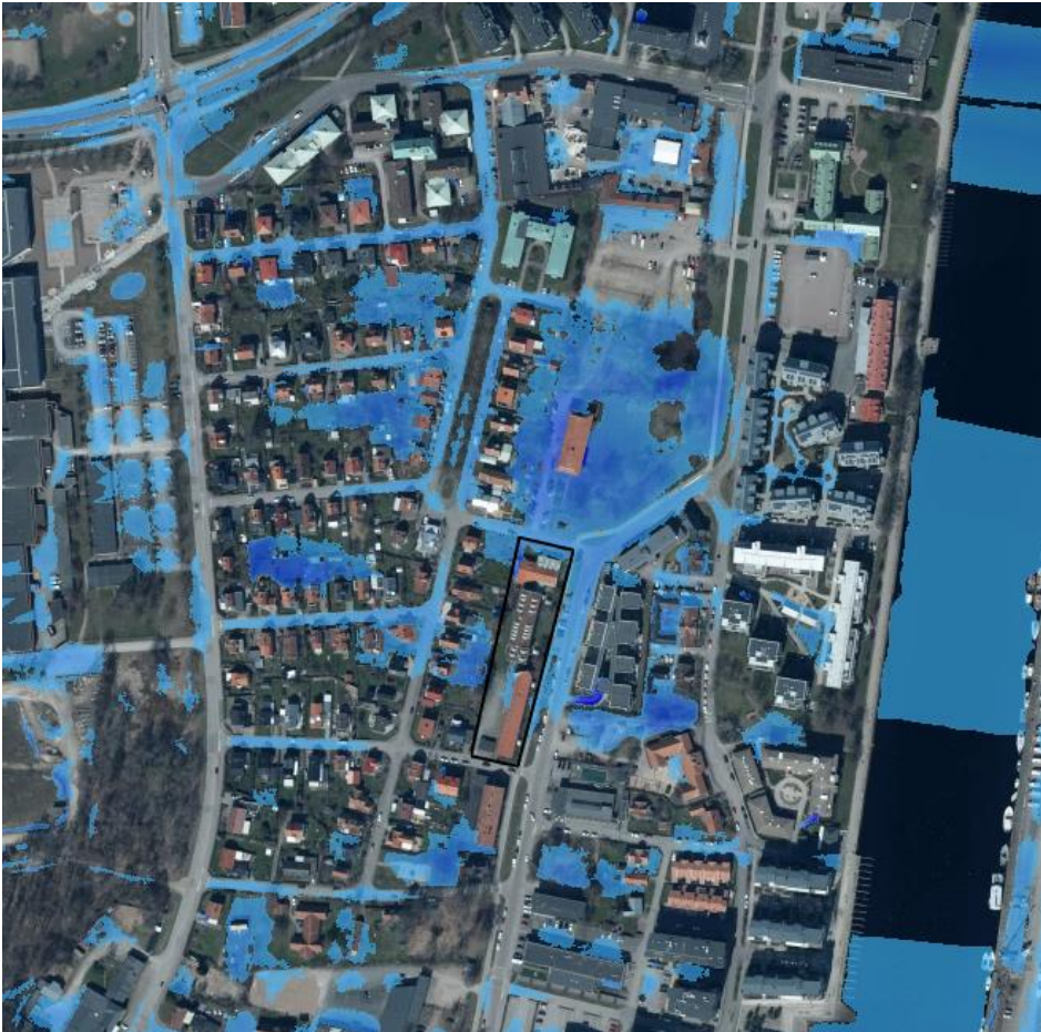
Figur 10 Lågpunktsanalys utförd i ScalgoLive. Figuren visar uppfyllnad av lågpunkter vid studerad regnvolym 71 mm. Detaljplanens ungefärliga gräns markerat i svart.
